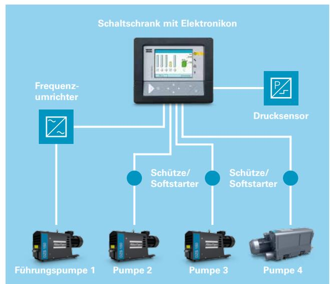
Die Steuerung ist in 4 Leistungsgrößen von 2,2 bis 22 kW pro Pumpe verfügbar und kann selbstverständlich auch bei Vakuumanlagen mit Drehschieberpumpen eingesetzt werden.
